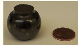
Abbildung 8. Gekrümmte nitrocarburierte Probe mit Brennflecken neben einem 2-Cent-Stück zum Größenvergleich.
